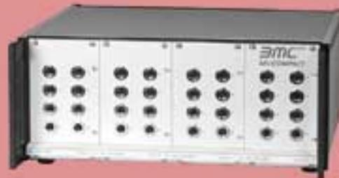
Verstärkerrack für 32 Meßkanäle, bestückbar mit 5B-Modulen oder Direktschaltung. 32 Sensor-Anschlußbuchsen 5-polig (Binder). 2 Ausgangsbuchsen 37-polig (Sub-D) auf der Rückseite. Netzteil extern
