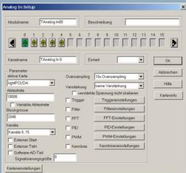
Durch Klicken des Buttons "Triggereinstellungen" erhalten Sie ein neues Fenster, in dem Sie die Bedingungen für den momentan gewählten Kanal definieren können. Stellen Sie einfach die gewünschten Parameter ein. In dem oberen Beispiel soll auf dem aktiven Kanal eine Grenze von 7,5 Volt überwacht werden. Überschreiten die Messwerte diese Grenze, so wird die AD-Messung gestoppt und der digitale Ausgang
