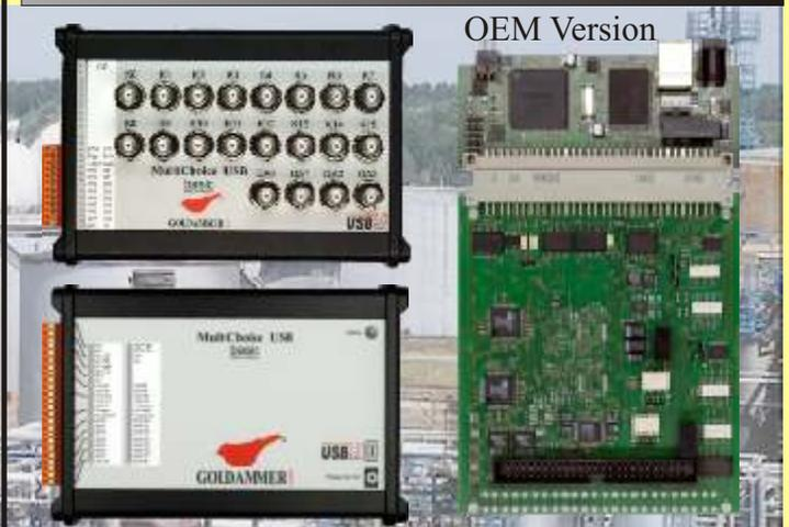
**12 Analogeingänge 16 Bit 225kHz pro Kanal galvanische Getrennt 500V**
