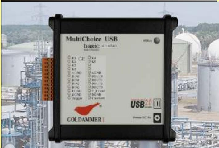
**6 Analogeingänge 16 Bit 225kHz pro Kanal galvanische Getrennt 500V**
